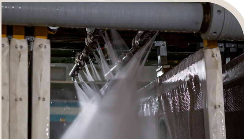
Sistema automático de lavado de las lonas con bomba centrífuga multietapa. Integrado en el bastidor de la máquina.
