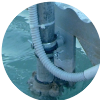
pH-Tauch-Sonde komplett mit Sender und Reinigungssystem
