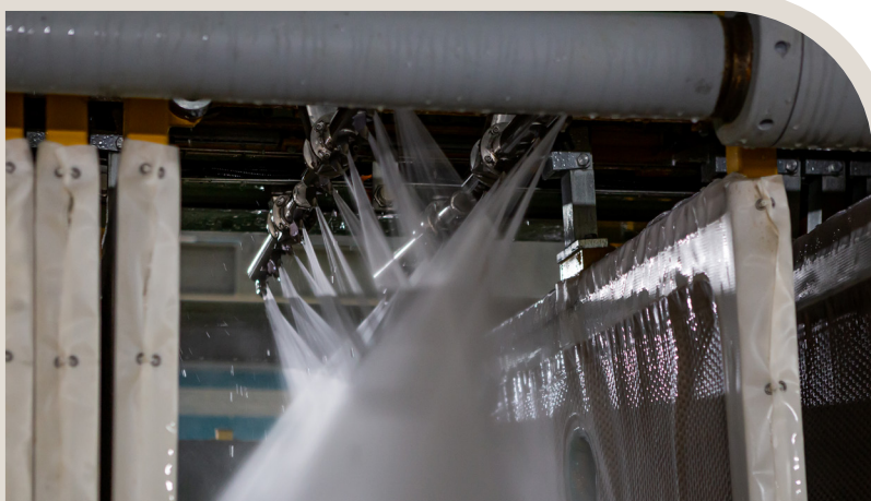
Système automatique de lavage des toiles avec pompe centrifuge multi-phase. Intégré dans le châssis de la machine.
